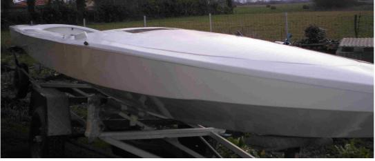
Fin de la restauration mars 2010 au bout d'un peu plus d'une centaine d'heures de travail. Poids de la coque 86kg et coût matière 200€ environ Prochaine étape l'accastillage et à l'eau !!!
