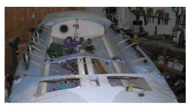
Nous avons utilisé : 5kg de résine époxy 2,5 kg de résine vinylester et 15m² de tissus
