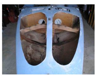
Le tissus délaminé est arraché et remplacé par un roving 300gr/m² imprégné soit de résine époxy ou de résine vinylester.
