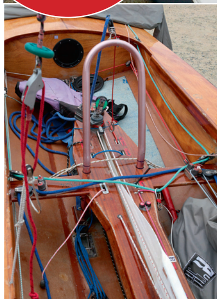
▲ Sur ce Fireball plus âgé, le point de tire de GV est avancé et l'écoute revient sur un arceau.
